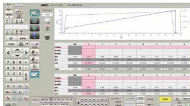
圈数程序屏幕（节距图：锥形弹簧成型示例）
